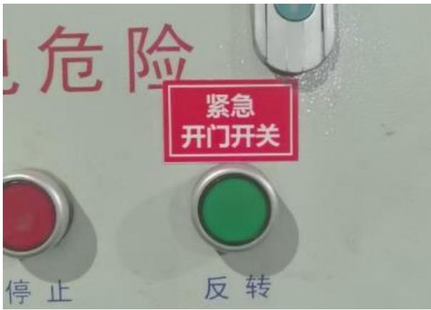
4# 工件防护门紧急开门开关
