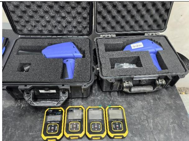
X-γ 辐射剂量巡检仪、剂量报警仪
