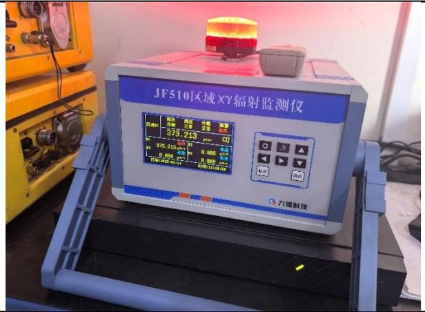
4# 在线剂量探测装置显示器
